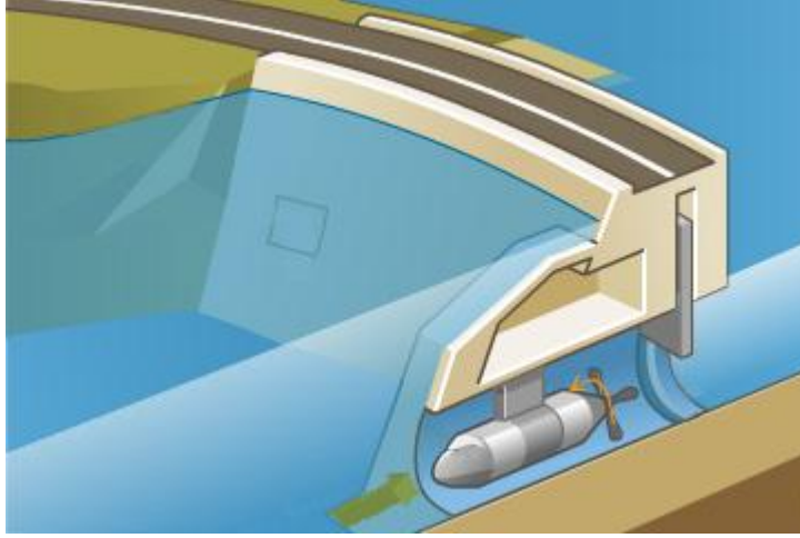
Şekil 10: Gel git barajı boşalırken türbin dönüyor
