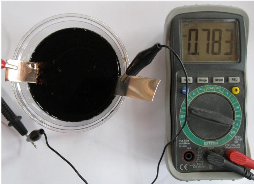
Resim 23: Kola, bakır ve alüminyum pili
