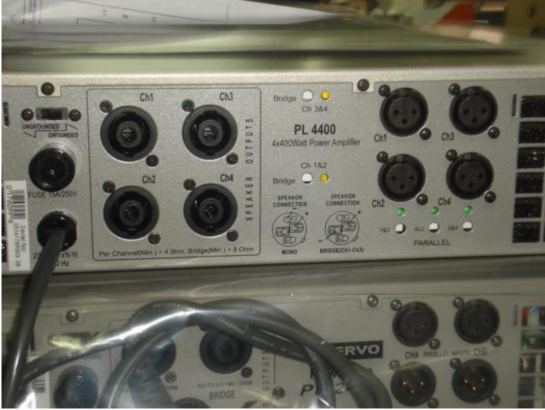
Resim 2.2: Amplifikatöre ait giriş çıkışlar
