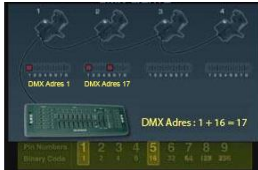
Resim 1.18: DMX uyumlu cihazların DMX adres pinlerinin ayarlanması
