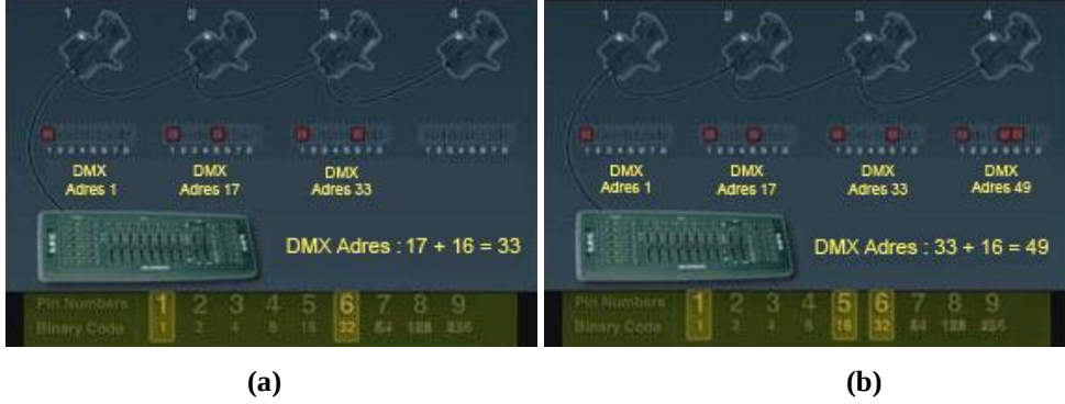
Resim 1.19: DMX uyumlu cihazların DMX adres pinlerinin ayarlanması
